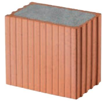
POROTON®-WDF ist ein zweischaliges Mauerwerk mit Putzschicht nach DIN 1053-1:1996-11 Abschnitt 8.4.3. Die Vorsatzschale besteht aus hochwärmedämmenden Ziegeln, POROTON®-WDF. Diese werden vor der bestehenden Wand aufgemauert und mit herkömmlichen Leichtputz verputzt. Dünnbettmörtel wird in ausreichender Menge mitgeliefert!
