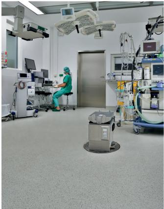
anderen elastischen Bodenbelägen müssen Kautschukböden nicht beschichtet werden. Dies spart nicht nur Zeit und Geld, sondern ermöglicht auch einen Rundum-Betrieb – 24 Stunden am Tag, sieben Tage in der Woche. Das ist gerade in Operationssälen extrem wichtig,
