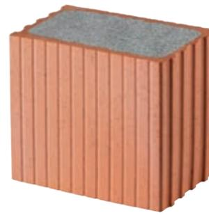
POROTON®-WDF ist ein zweischaliges Mauerwerk mit Putzschicht nach DIN 1053-1:1996-11 Abschnitt 8.4.3. Die Vorsatzschale besteht aus hochwärmedämmenden Ziegeln, POROTON®-WDF. Diese werden vor der bestehenden Wand aufgemauert und mit herkömmlichen Leichtputz verputzt. Dünnbettmörtel wird in ausreichender Menge mitgeliefert!
